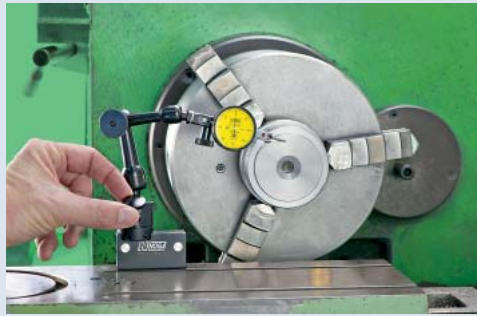
ワーク端面に側面からあてる (微調整ねじの位置は手前)
