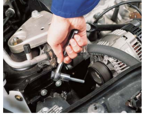
六角ボルトナットを落とさないマジックソケット&ビット
