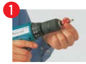
1 スリーブを中に押し込みます。
