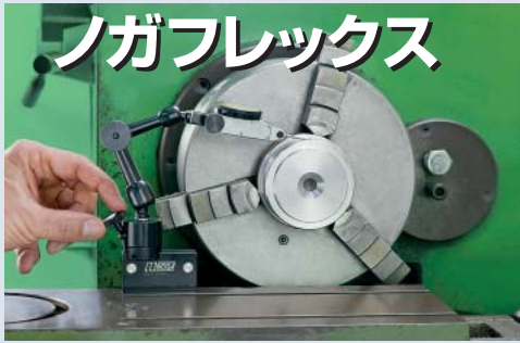
〈旋盤上での使用例〉 丸物ワークに上からあてる
