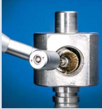
フェアッド社の豊富な研磨用繊維材種により、様々なワーク材種のクリーニング、バリ取り、磨きに最適の繊維フィラメントをお選びいただけます。フェアッド社のミニチュアブラシは、フレキシブルシャフト、エアーモーターや電気グラインダーでご使用になれます。
