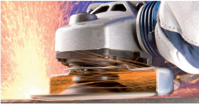
CC-GRIND-SOLIDのユニークな取り付け方法により、ほぼ平らのアングルでの研削作業もできます。
