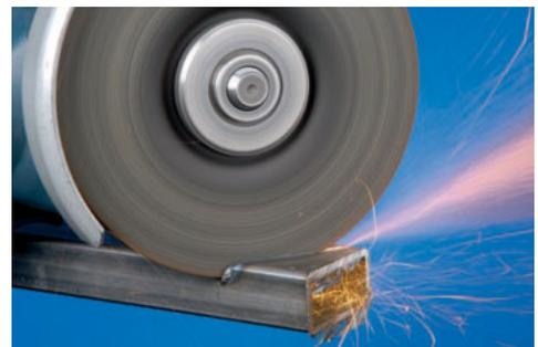
食い付きのよい砥粒と高品質のボンドにより高い能力を顕します。1.9mm厚は速い切断とバリ取りに、2.8mm厚はより粗加工に適し、長寿命です。
